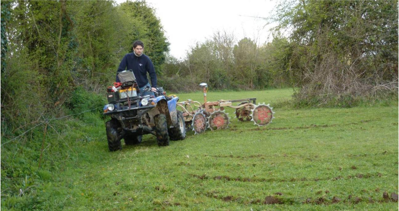
**Figure 86 : Prospection électrique tractée dans la parcelle ZK55**
