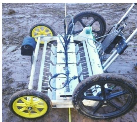
Figure 4 : Géoradar IDS avec 5 antennes 600MHz
