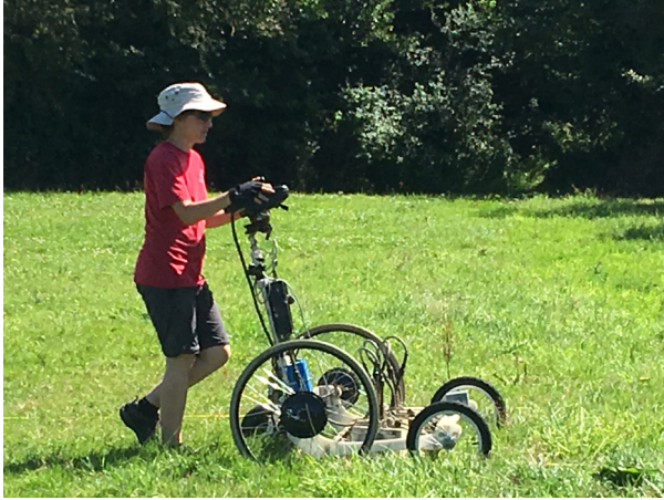
Figure 3 : Le chariot autopropulsé supportant les antennes et l'ordinateur (cliché L. Jeanne)
