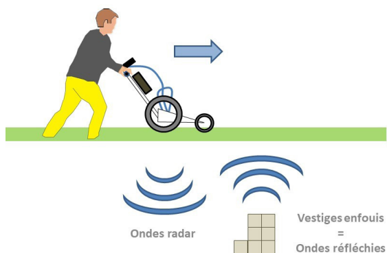
Figure 1 : Principe de fonctionnement du géoradar (croquis D. Lepoittevin).
