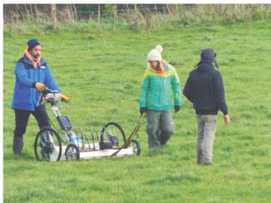
→ Non, ces scientifiques catalans ne poussent pas une tondeuse dans les prairies sous lesquelles sommeille la cité d'Alauna, mais un appareil géoradar.
